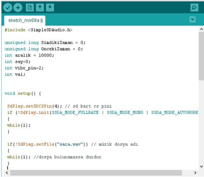
Şekil 4: Arduino IDE programı ile yazılımın derlenmesi ve aktarılması.
