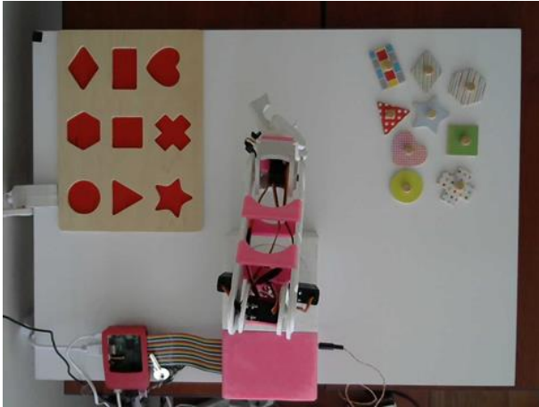
Şekil 8. Bul-tak nesneleri görüntü işleme sonucu robot kol ile yer değiştirme sonucu
