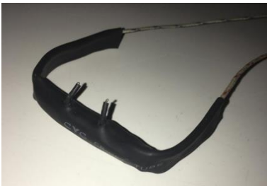
Şekil 5. Solunum süresi ölçüm algılayıcı
