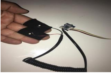
Şekil 4. GSR algılayıcı ve bağlantısı
